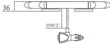
Varning: När blixtljusrampen är monterad med magneffäste på taket får fordonet endast framföras i låg hastighet. Framförs fordonet i hög hastighet kan blixtljusrampen lossna och orsaka skada på fordonet. Det är förarens ansvar att framföra fordonet i en lämplig och säker hastighet.
